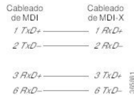
Figura 14: Patillaje de cable directo a un hub, repetidor o switch
