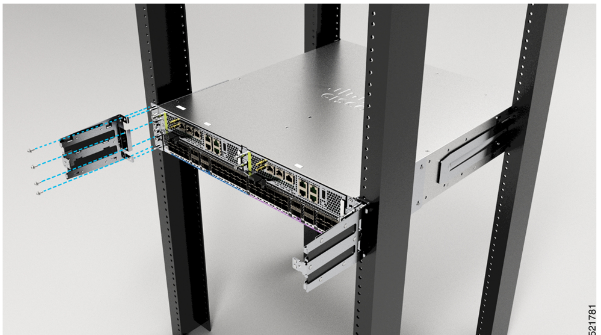
Figura 126: Instalación y retirada del soporte de gestión de cables del router ASR 9902 de Cisco
