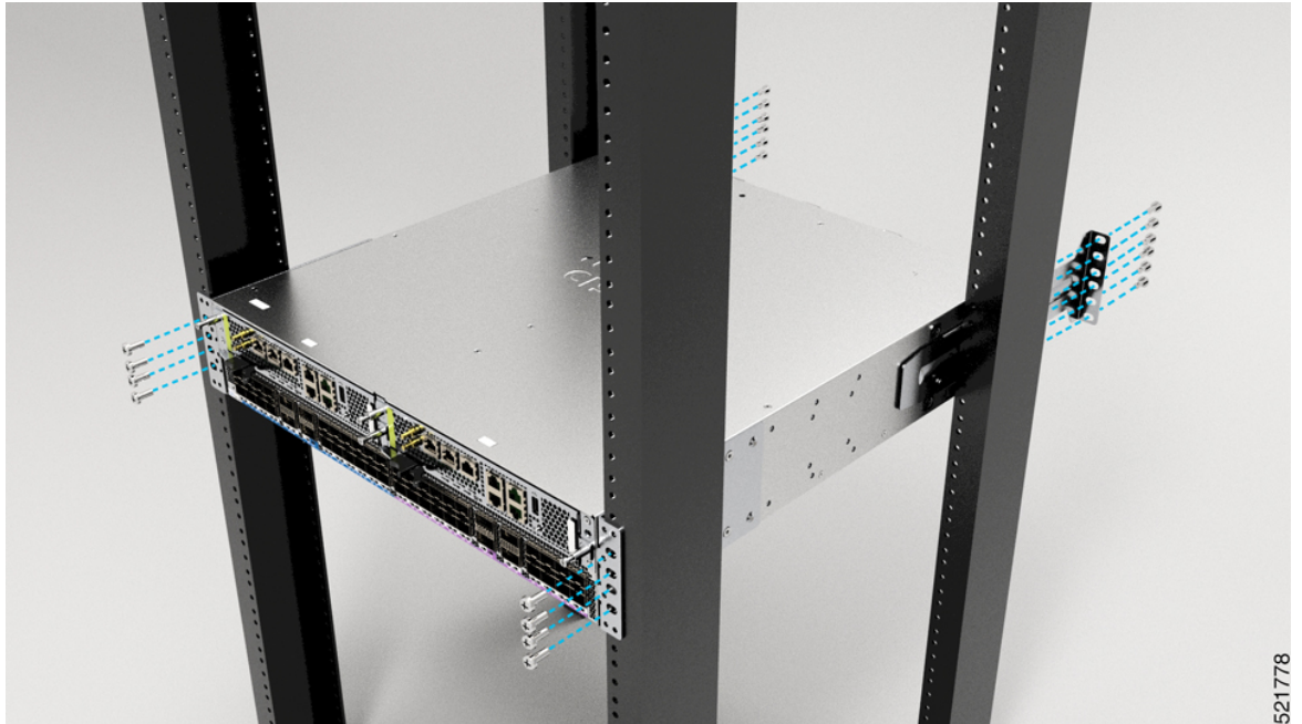
Abbildung 84: Cisco ASR 9902: Schrauben an den Rack-Schienen anziehen (19-Zoll-Rack mit 4 Säulen) – Rückansicht
