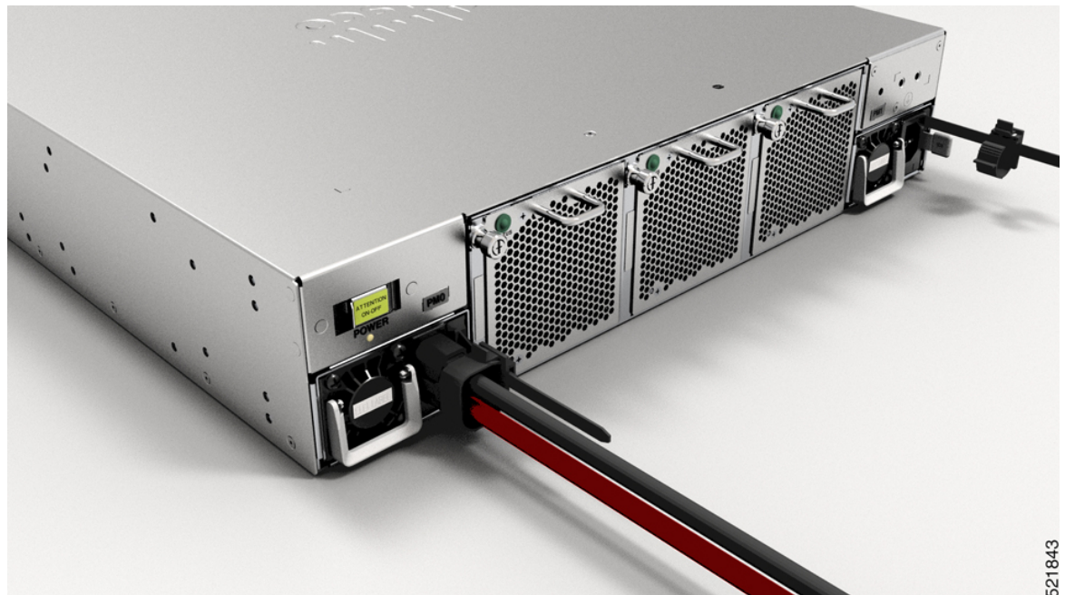
Abbildung 68: Verkabelungsschema für Gleichstromquelle beim Cisco ASR 9902
